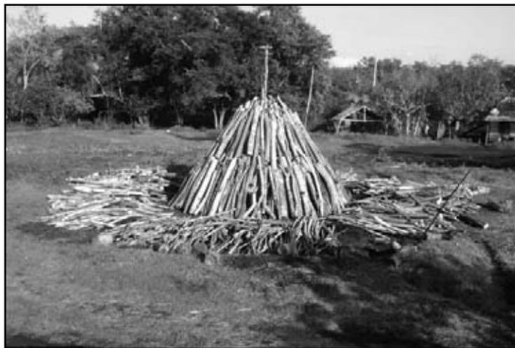
*El levantamiento de un cono de madera (leña) es conocido, en el mundo de la ciénaga como horno para fabricar carbón vegetal, este de la instantánea se levanta en el plan de carbón nº 7, se puede apreciar toda su estructura y la forma de su confección.*
