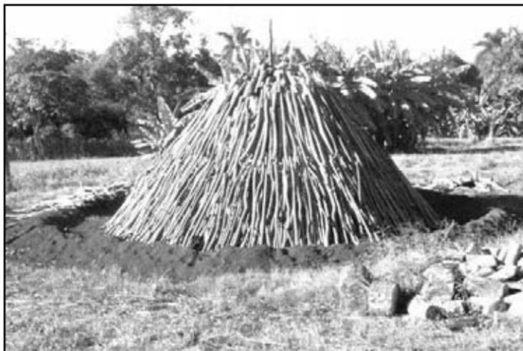
*Plan de quemar carbón vegetal n° 7, construido después del triunfo de la Revolución, puede observarse un horno de más de tres metros de alto, al centro del cono se puede ver el pion, y en los laterales las cuñas de madera para las futuras bocas de candela que puedan abrirse, al fondo las plataneras que siempre acompañaron al gallego en su habitat.*
