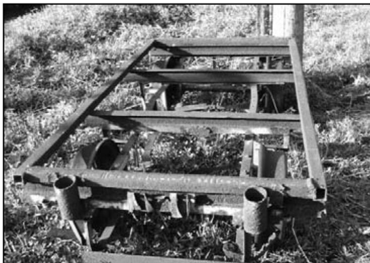
*Carro de line de ferrocarril, utilizado dentro de los montes para el traslado de la madera y leña desde el corte hasta los planes de carbón o la madera para embarcar hacia los almacenes, este carro era tirado desde un extremo por un motor fijo unido a un largo cable de metal, la facilidad de su desplazamiento al lugar deseado era la ventaja más humana que tenia este tipo de transporte de carga, desde 1935 adelante fue utilizado, en distintas zonas de los dominios de los Moa u otro propietario.*
